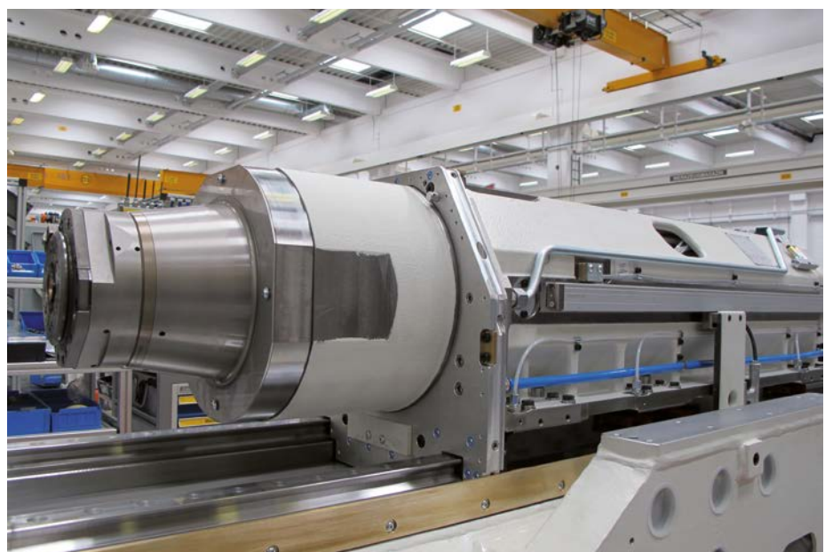
Abbildung 5: HEIDENHAIN-Längenmessgerät in einem Horizontalbearbeitungszentrum (Foto: GROB-WERKE GmbH & Co. KG)
