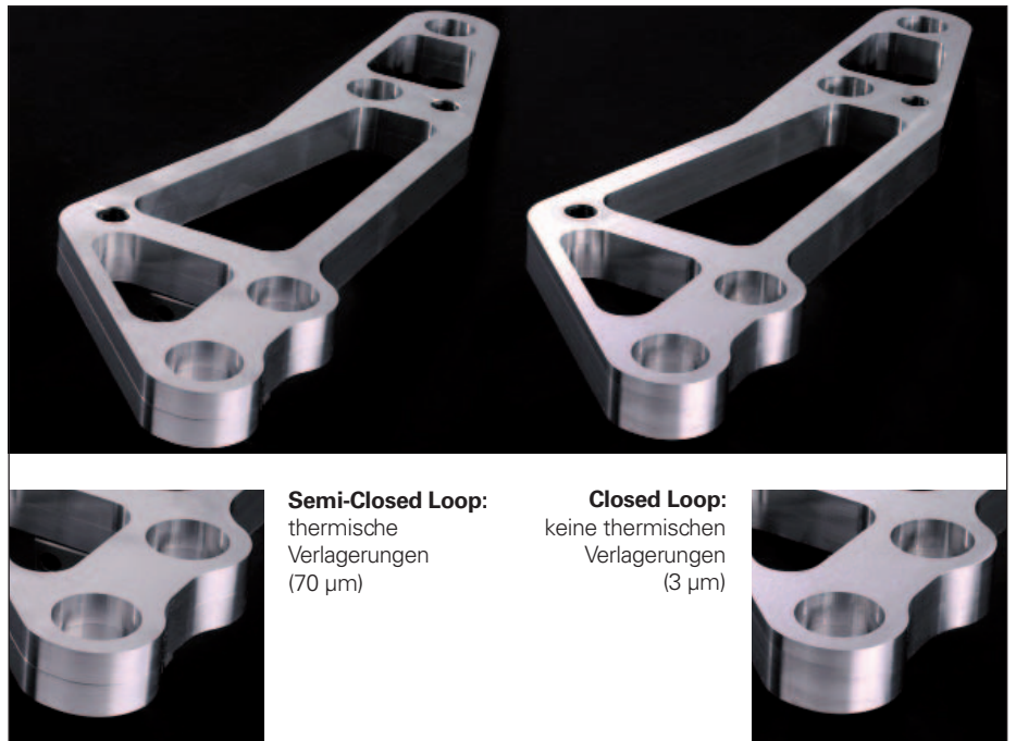
Abbildung 5 Hebelbauteil, zweifach auf einem Rohling bearbeitet
