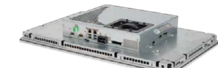
MC 366 mit rückseitig angebautem Hauptrechner
