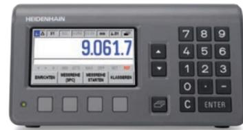
Die Auswerte-Elektronik ND 287 für eine Achse ist aufgrund ihres Funktionsumfangs prädestiniert für Mess- und Prüfplätze, aber auch für einfache Positionieraufgaben. Der universell aufgebaute Messgeräte-Eingang erlaubt den Anschluss aller inkrementalen Messgeräte mit 11- $\mu$ ASS- und 1-VSS-Signalen und der absoluten Messgeräte mit EnDat-2.2-Schnittstelle von HEIDENHAIN.
